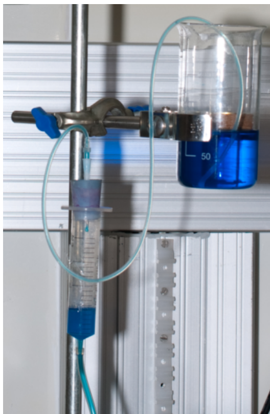
Kuva 6.2: Virtausjärjestely, jossa nähtävillä liuosvarastona toimiva dekantterilasi, byretti, näitä yhdistävä 1 mm:n muoviletku sekä byretistä lähtevä 3 mm:n muoviletku
