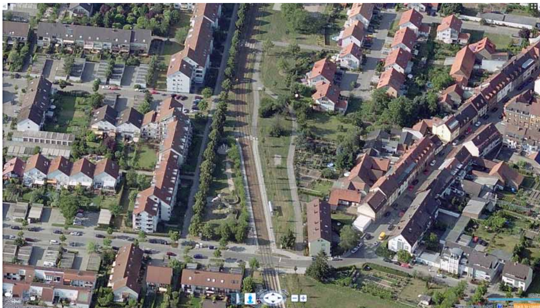
Kuva 21. Raitiotiellä toteutettu sisäsyöttöinen korttelirakenne Karlsruhen Durlachissa Saksassa. Raitiotierata on kuvan keskellä, kuvan alareunassa kulkee korttelia reunustava kokoojakatu. Radassa näkyvä suora osa kuvassa kadun yläpuolella on pysäkki. Pysäkin vasemmalla puolella on aidattu lasten leikkialue, joka näkyy seuraavassa kuvassa (Kuva 22). Kulku pysäkeille on laajalta alueelta mahdollista ylittämättä vilkasliikenteisiä pää- ja kokoojakatuja. Kuvälähde Microsoft Bing Maps 2010.
