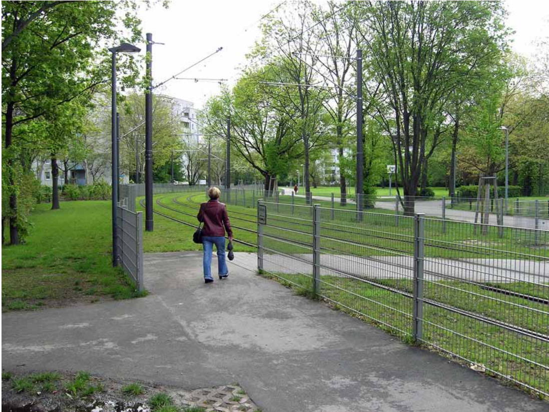
Kuva 25. Kävely-ympäristöä Saksan Karlsruhen Durlachissa (katso myös Kuva 22), jossa raitiotie on puistossa. Kuvassa myös Z-muotoinen radan ylittävä kävelytie, joka ohjaa jalankulkijan näkemään raitiovaunun tulosuuntaan.
