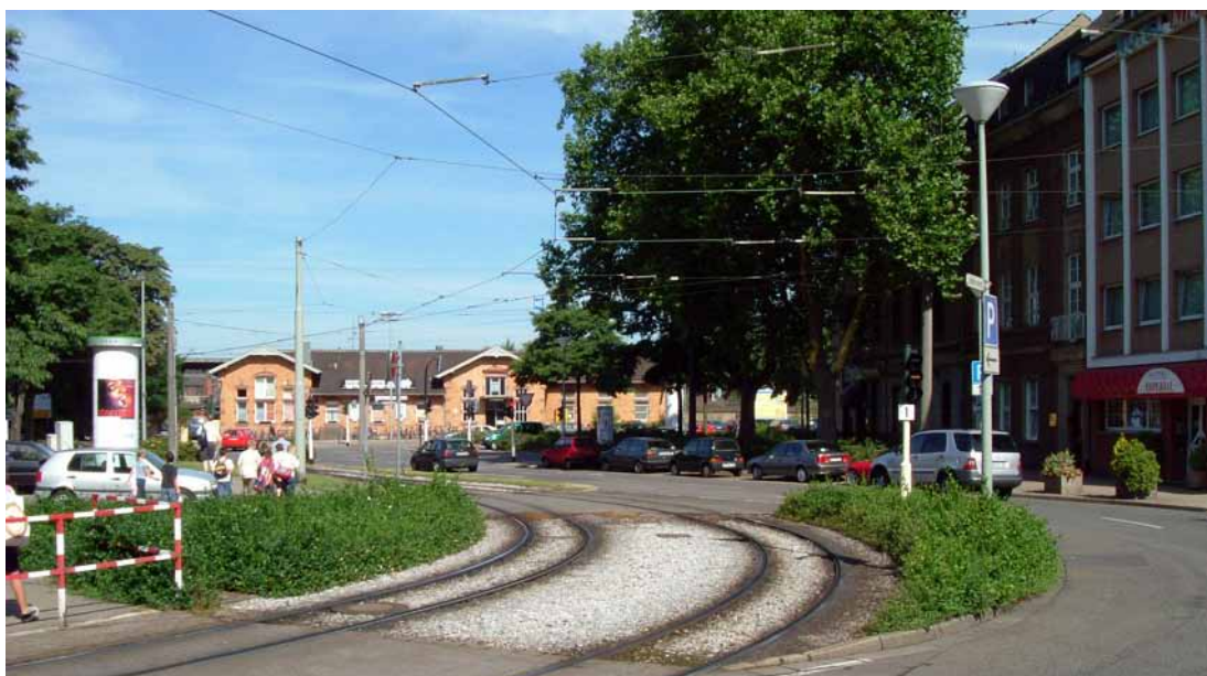
Kuva 11. Raitiotien etuus risteyksessä ohittamalla risteys. Autojen ajo ohituskaistalle on estetty radan sepelipinnalla. Kuva Uerdingen, Saksa vuodelta 2003.
