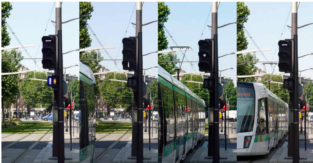
Kuva 12. Liikennevaloetuuden toiminta Pariisin linjalla T3. Vasemmalla vaunun lähestyessä SEIS-opastetta opastimen alapuolella oleva sininen huutomerkki ilmoittaa, että vaunu on havaittu ja opastinta voi lähestyä hiljentämättä nopeutta. Kun vaunu tulee opastimen kohdalle, opastin vaihtuu näyttämään AJA-opastetta. Kun vaunu on risteyksessä, AJA-opaste vaihtuu varoitusopasteeksi ja vaunun ohitettua opastimen se näyttää jälleen SEIS-opastetta. Kuvat vuodelta 2010.
