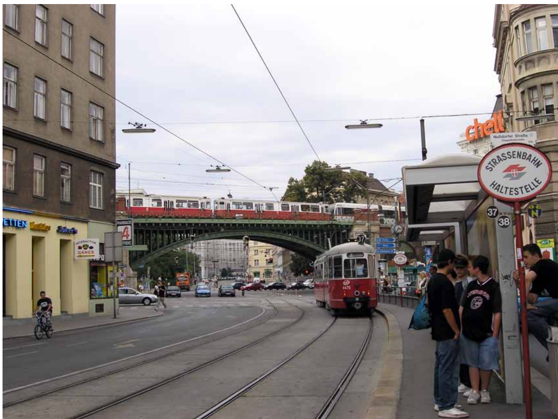
Kuva 4. Wienin metrolinjaksi nimetty U6 (U=Untergrund) on pääasiassa ilmarata, jota on alun perin liikennöity höyryveturivetoisin junin osana Wienin Stadtbahnia. Nykyään radan junat (kuvassa sillalla) koostuvat nivelraitiovaunuista, joista vanhemmat ovat rakenteeltaan samanlaisia kuin Wienin katuverkossa liikkuvat raitiovaunut. Kuva vuodelta 2004.
