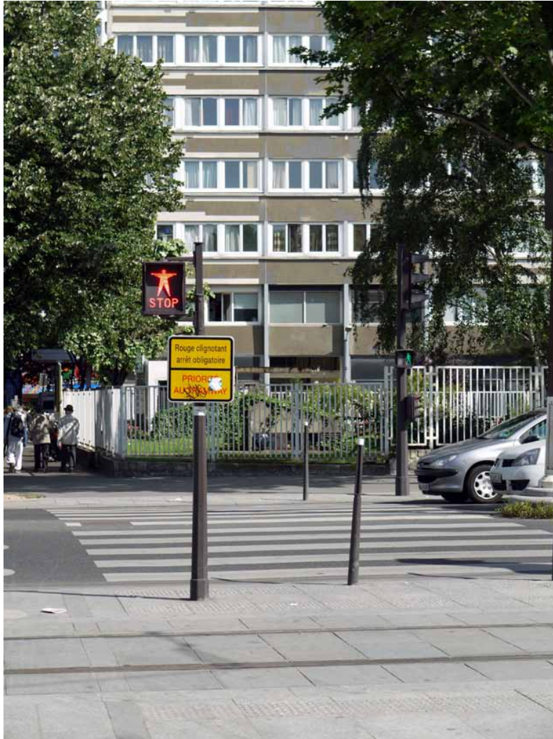
Kuva 13. Jalankulkija on Ranskassa lain mukaan aina velvollinen väistämään raitiovaunua. Raitiovaunun lähestymisestä varoitetaan lisäksi jalankulkijan SEIS-opastimella. Opastimen lisäksi muistuttaa pakollisesta pysähtymisestä punaisen valon palaessa sekä raitiovaunun etuoikeudesta. Raitiotien ja ajoradan liikennevalot eivät ole toisiinsa sidottu. Ajoradan ylittävällä suojatiellä on kuvaushetkellä jalankulkijalle vihreä opaste ja autot seisovat punaisella opastimella. Kuva Pariisista vuodelta 2010.
