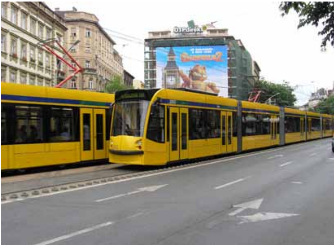
Kuva 15. Raitiovaunu- ja autokaistan erotus kaistojen väliin valettujen betoninystyjen avulla Unkarin Budapestissä 2006.
