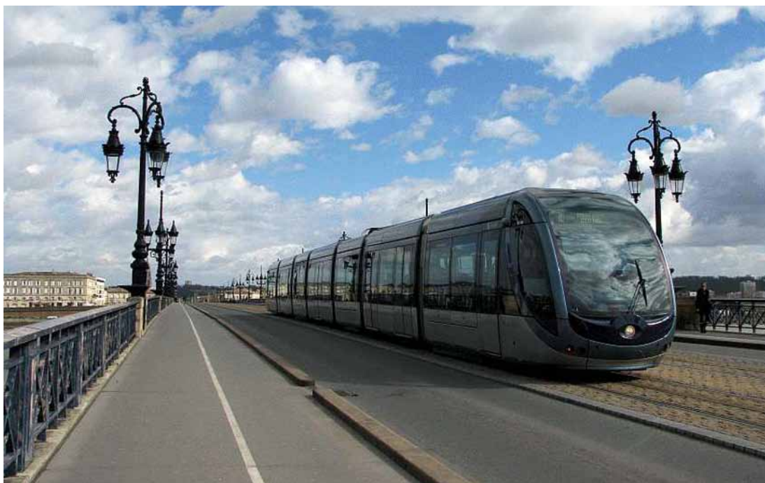
Kuva 7. Raitiovaunu ilmajohdottomalla radalla Ranskan Bordeaux'ssa. Vaunu saa sähkön keskimmäisestä kiskosta. Kisko on jännitteinen ainoastaan vaunun alla olevalla osuudella, joka aktivoituu tunnistettuaan vaunun olevan kohdalla. Kuva Vladimir Waldin 2009.
