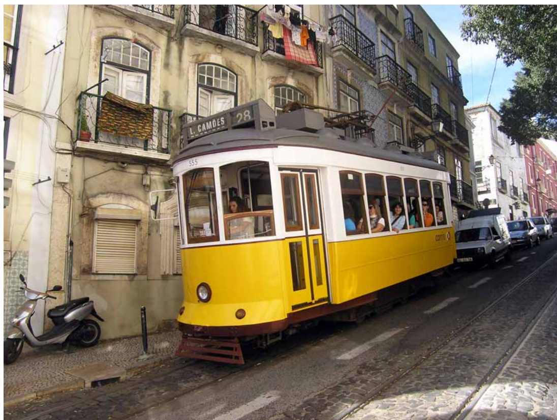
Kuva 8. Raitiovaunun pystykaltevuutta rajoittaa pyörän ja kiskon välinen liukukitka. Kuvan vaunun kohdalla kadun ja raiteen kaltevuus on 7,5 astetta eli 13 prosenttia. Kuva Portugalin Lissabonista 2006.
