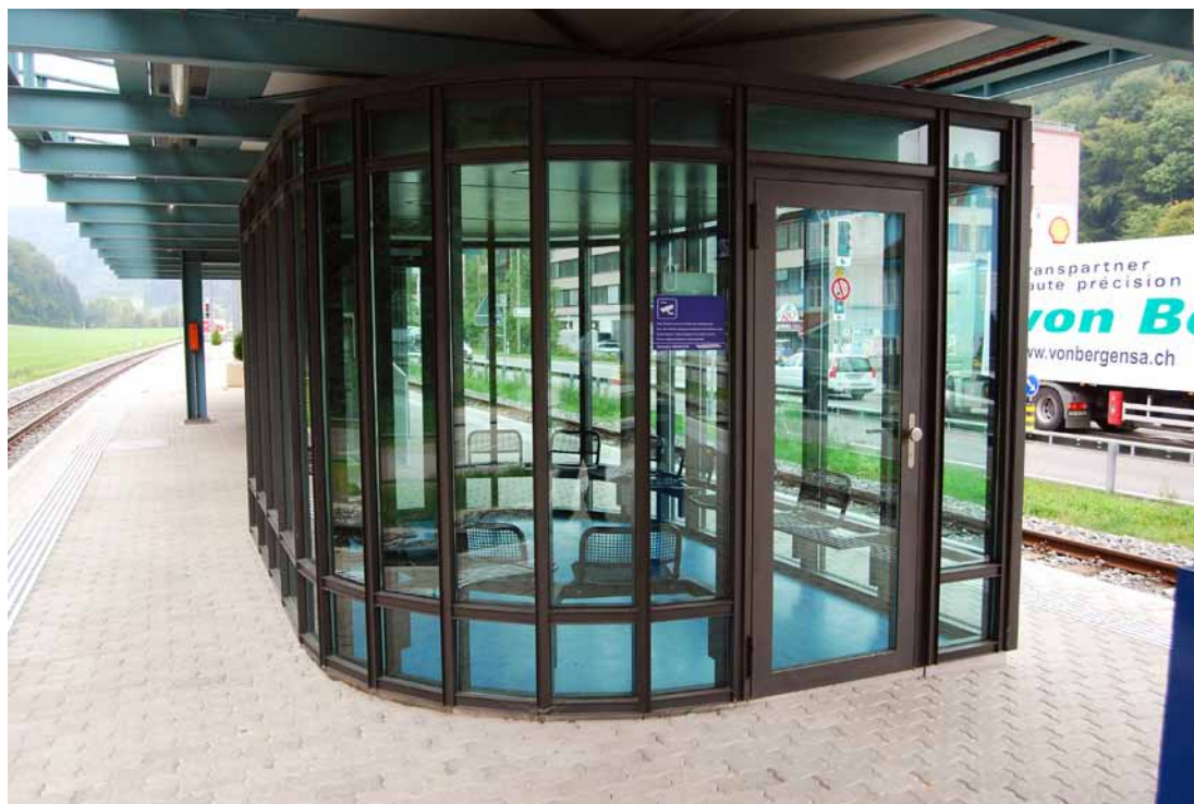
Kuva 18. Pysäkkikatoksen yhteyteen rakennettu kevyt täysin säältä suojattu odotustila. Schöneeggstrasse, Sveitsi, kuva Daniel Federley 2010.
