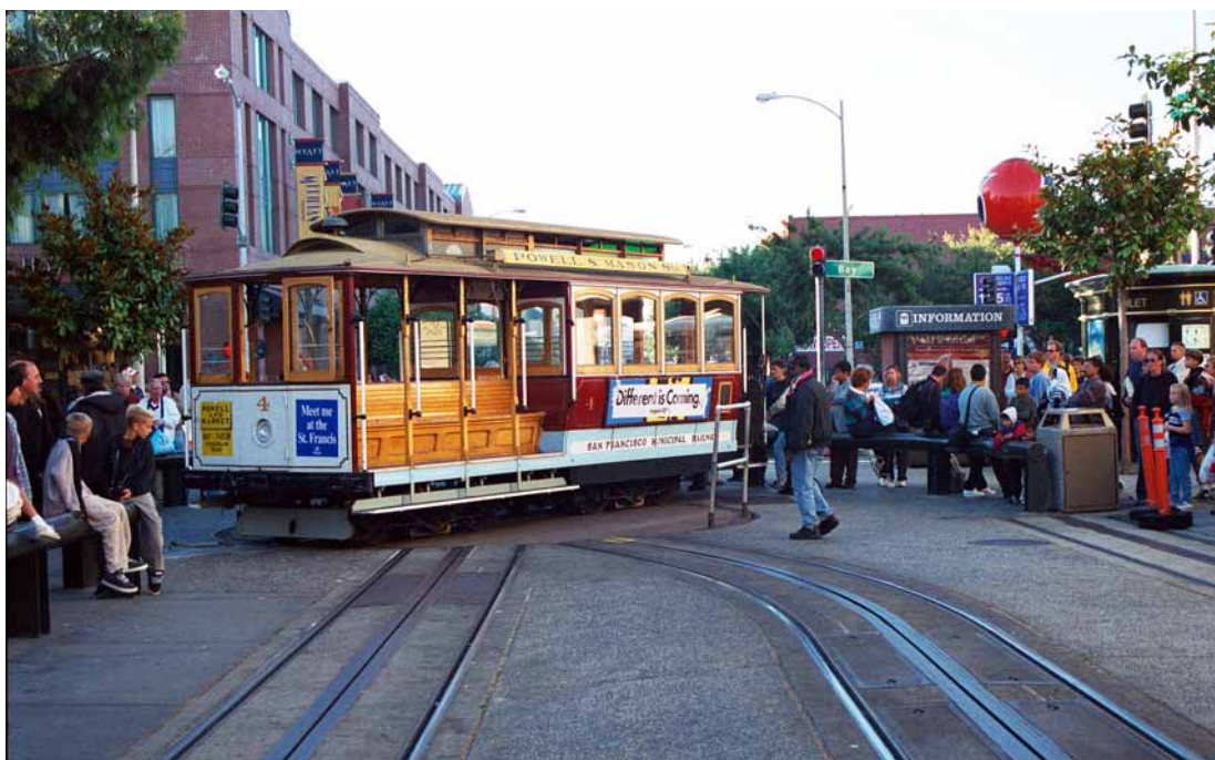
Kuva 2. Vaijerivetoinen raitiovaunu linjan päässä olevalla kääntöpöydällä. Vaunu työnnetään kääntöpöydälle ja pöytä kierretään käsin. Vaunun valaistus toimii akulla. USA:n San Franciscon vaijerivetoinen järjestelmä avattiin 1873. Jäljellä on kaksi linjaa, joiden kalusto on samanlaista kuin alkuperäiset vaunut. Kuva vuodelta 1999.
