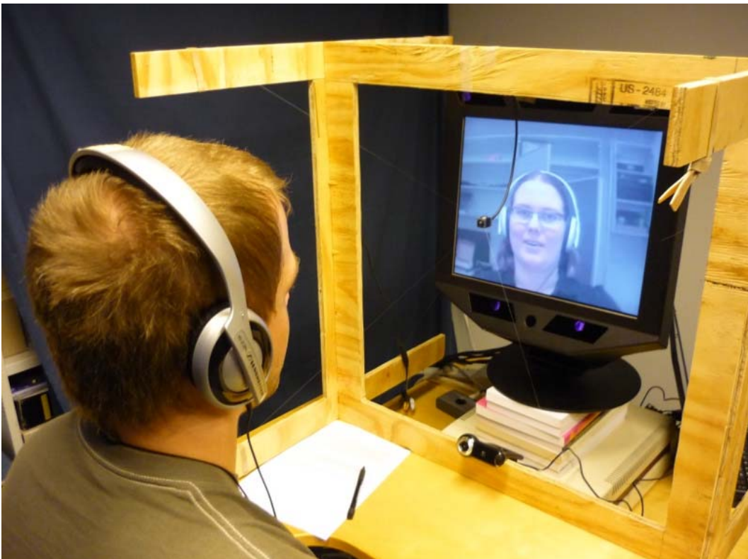
Kuva 7. Koehenkilö kommunikoi toisen koehenkilön kanssa video- ja ääniyhteyden välityksellä, samalla kun katseenseurantalaite mittaa minne hänen silmänsä katsovat.
