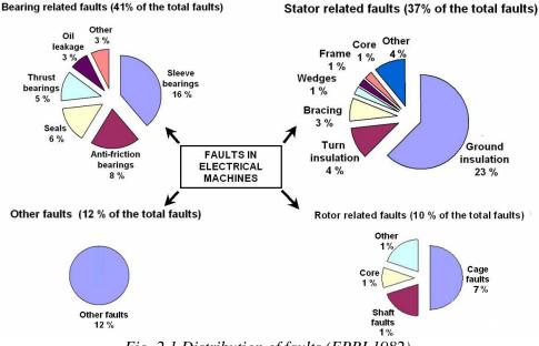
Fig. 2.1 Distribution of faults (EPRI 1982).
