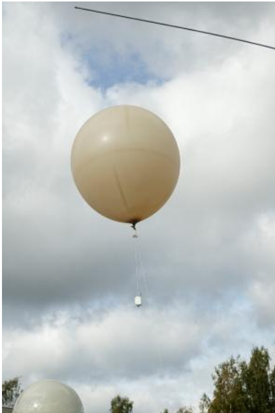
Kuva 2: Radiosondi lähettää säätietoja maanpinnan yläpuolelta jopa 30 km:n korkeudelta. [3]
