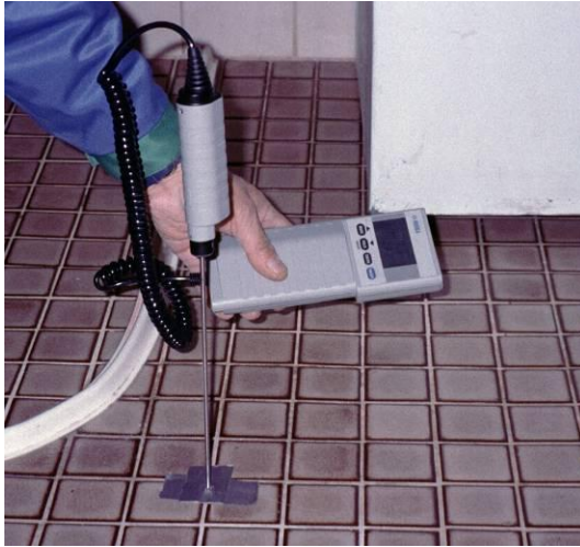
Kuva 3: Käsimittarin käyttö kylpyhuoneen lattian kosteusmittauksessa[3]
