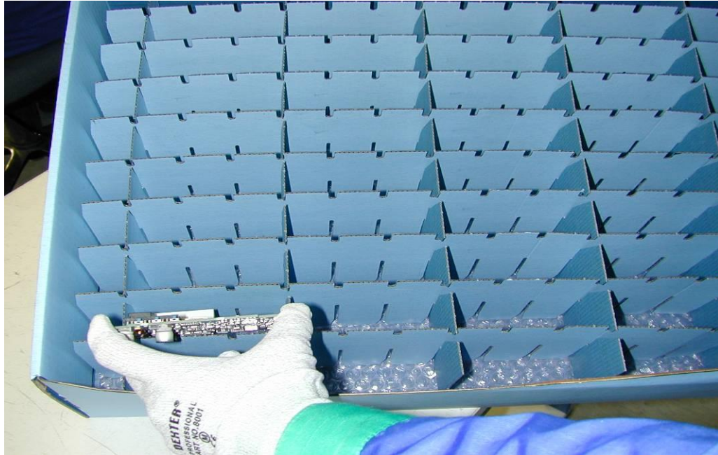
Kuva 22: ESD-suojattu pakkauslaatikko välilokeroituna, pohjalla kuplamuovipehmuste. Levyjä käsitellään puhtailla ESD-hansikkailla.
