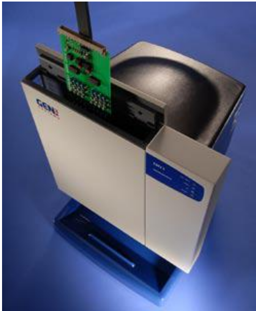
Kuva 16: Gen3 systemsin puhtaudenmittauslaite, eli kontaminometri [32]
