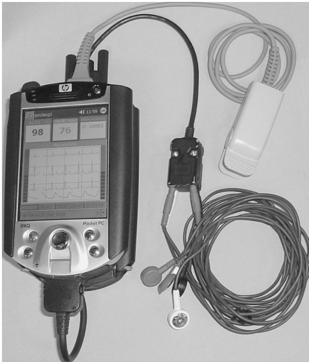
Kuva 5. WLAN-pohjainen kannettava langaton pulssioksimetri ja kolmipäinen EKG-monitori [Lin ym. 2004].
