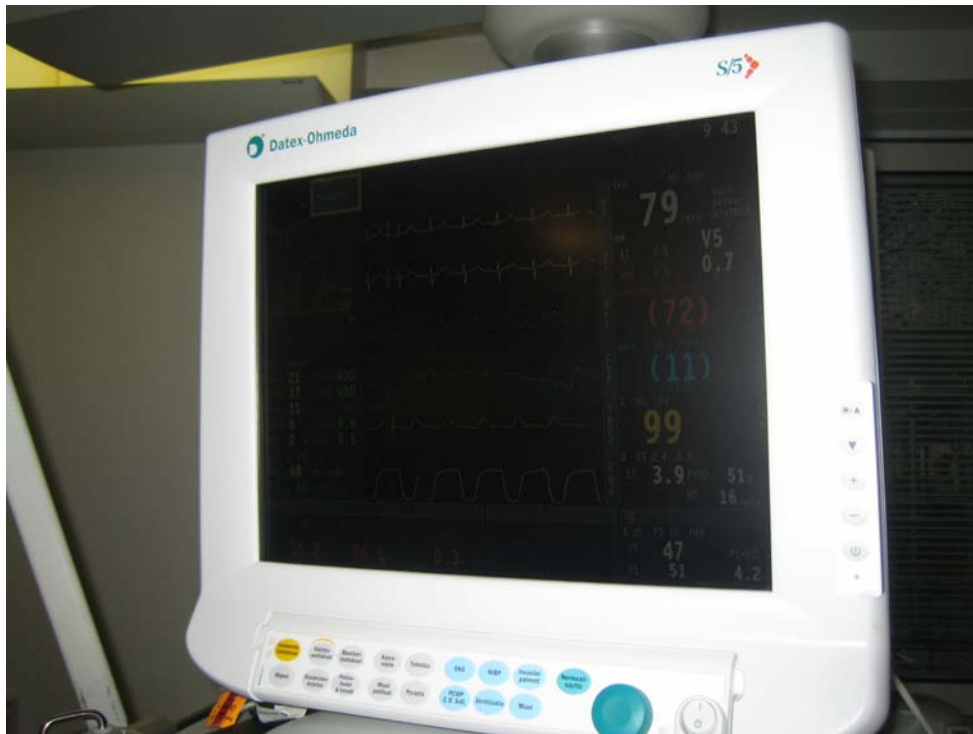
Kuva 16. Datex Ohmeda yleismittari (valmistaja GE Healthcare Finland). Mittaa EKG:n, verenpaineet sekä CVP-katetrin.
