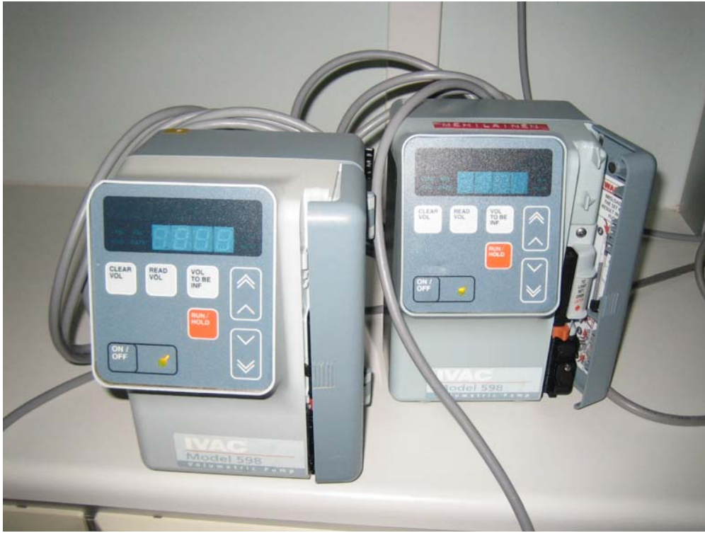
Kuva 19. Ivac-infuusiopumppuja. Niitä käytetään tiputuksessa (2 kpl) (Model 98 / Oriola).
