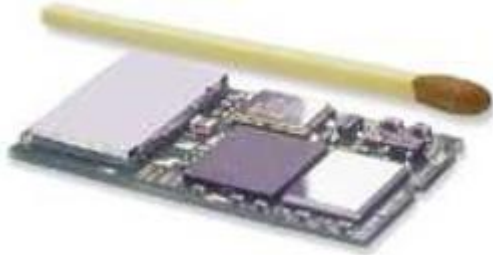
Kuva 7. Bluetooth-piirisiru. Vertailun vuoksi kuvassa on tulitikku [Wang 2001].
