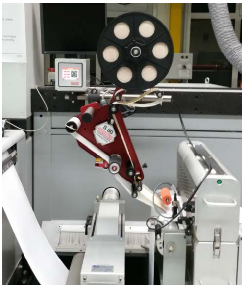
Abbildung 4-16: Für die Durchführung der Druckversuche nachträglich an die Druckmaschine montierter Etikettenspender für das Inlinespenden von Etiketten
