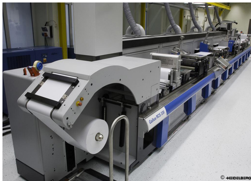
Abbildung 4-1: Modulare Rollendruckmaschine Gallus RCS 330-HD des Instituts für Druckmaschinen und Druckverfahren der TU Darmstadt
