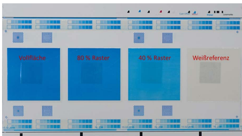
Abbildung 4-3: Druckmotiv der Druckproben, welches sich aus einer Vollfläche, einem 80 %-Raster, einem 40 %-Raster und einer Weißreferenz zusammensetzt (von links nach rechts) [Gute16]
