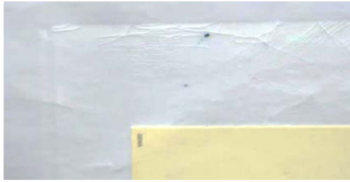
Abbildung 4-4: Bersten der Lackschicht (Vorversuch mit Siebdrucklack des Unternehmens PRÖLL) [GUTE16]
