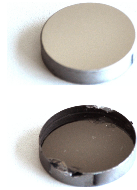
Abbildung 6.5 Oberseite des Substrats mit Chromschicht (oben) und Unterseite des Substrats (unten): Im Vergleich zur Oberseite ist unten die weniger reflektierende und dunklere Chromnitridschicht erkennbar (Veranschaulichende Abbildung eines 5 mm dicken Substrats).
