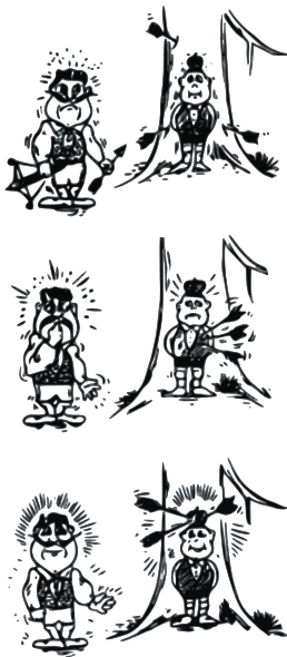
Abbildung 6.10 Oben: Schlechte Richtigkeit, schlechte Wiederholbarkeit. Mitte: Schlechte Richtigkeit, gute Wiederholbarkeit. Unten: Gute Richtigkeit, gute Wiederholbarkeit. Entnommen aus Adunka 1
