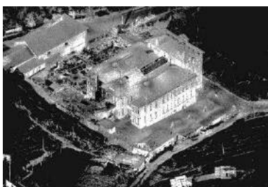
Fig. 29 – Nuvem de pontos resultante do varrimento laser, a partir dos quais são realizados os desenhos CAD
