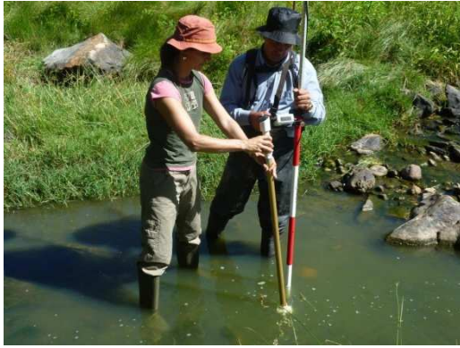
Figura 13. Medições de velocidade e profundidade ao longo das secções transversais no troço OCBA.
