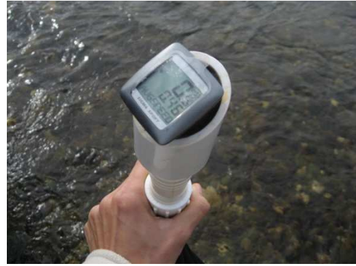
Figura 13. Medições de velocidade e profundidade ao longo das secções transversais no troço OCBA.
