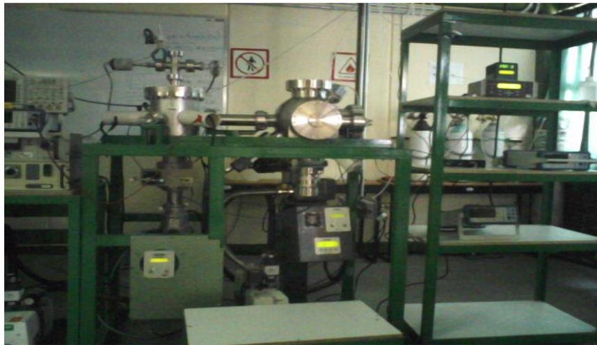
Antes de producir cualquier descarga luminiscente en este dispositivo, se debe limpiar la cámara de vacío. Transcurrido el proceso de limpieza y habiendo colocado los electrodos dentro de la cámara a la separación necesaria se procede a suministrar el gas y a estabilizar el sistema para que finalmente se aplique el voltaje a los electrodos de cobre y se produzca una descarga luminiscente<sup>24, 25, 26, 27, 28, 29</sup>.
