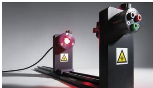
Figura 19. Autolab LED Driver Kit empleado para la obtención de curvas i vs V.
