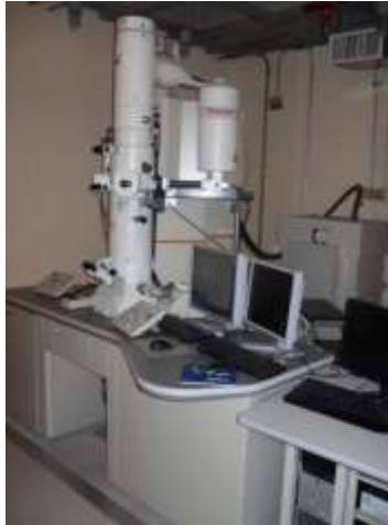
Figura 3.4 TEM modelo JEM-2001, Centro Conjunto de Investigación en Química Sustentable [69]
