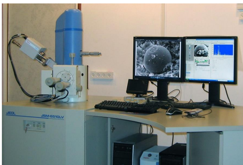
Figura 4.2 Microscopio Electrónico de Barrido JEOL JSM 6510 LV.
