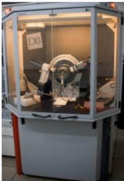
Figura 4.4. Difractometro bruker D8 Avance
