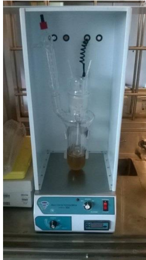
Figura 4.7 Reactor de fotoquímica Q-200, marca Prendo.
