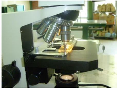
Figura 10. Conteo en el microscopio con la cámara de McMaster
