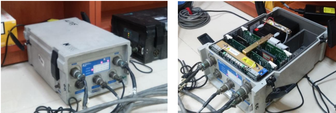
Figura 4.2.5 Grabadora de registro de aceleraciones (Altus/K-2)
