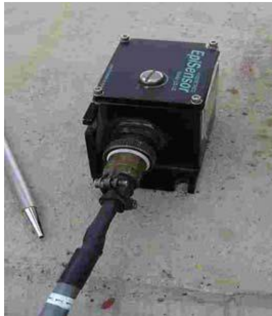
Figura 4.2.4 Acelerómetros uniaxiales Episensor FBA ES-U2
