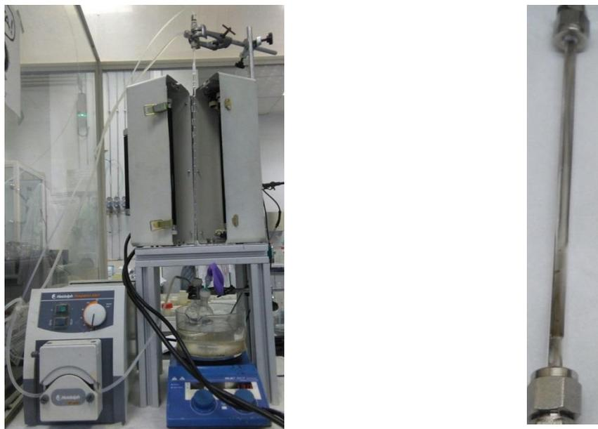
*Figura 42. Izquierda: Sistema de reacción para la reducción de  $\text{CO}_2$  con  $\text{H}_2\text{O}$  catalizado por  $\text{Cu}_2\text{O}$  depositado sobre multicapas de grafeno. Derecha: Detalle del capilar recubierto.*
