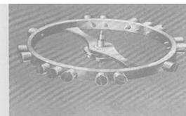
2 El volante de calidad de un mecanismo con *áncora de rubíes* es ajustable, inoxidable y adaptable a los cambios de temperatura. Este volante es factor fundamental para regular el reloj con máxima precisión.
