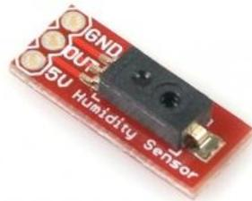
FIGURA 15. SENSOR DE HUMEDAD HIH-4030. TOMADO DE COSAS DE INGENIERÍA
