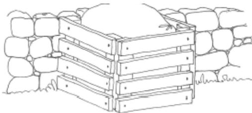
FIGURA 5. COMPOSTADOR DE PALOS DE MADERA. TOMADO DEL MANUAL DEL BUEN COMPOSTADOR
