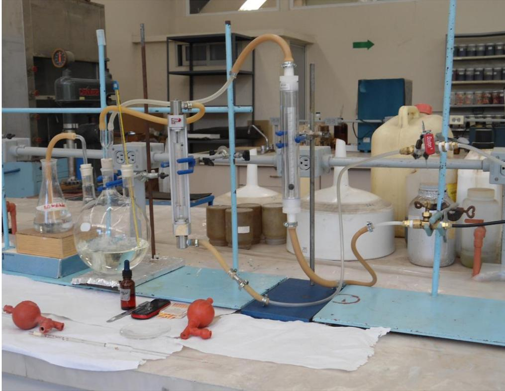
**Figura 5.-** Experimentación para determinar la captura de  $\text{CO}_2$  con etanol amina (EA) al 30% a diferentes flujos simultáneos de  $\text{CO}_2$ .
