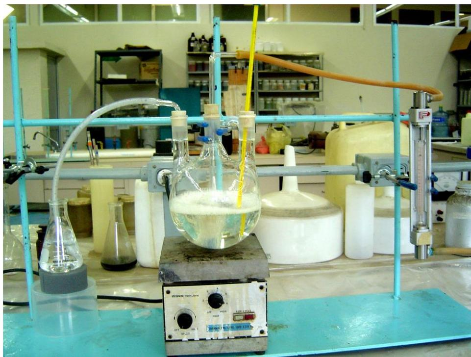
**Figura 4.-** Experimentación para determinar la participación del O<sub>2</sub> y del aire en la pérdida de etanol amina en los sistemas EA-H<sub>2</sub>O-Aire, EA-H<sub>2</sub>O-O<sub>2</sub>.
