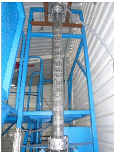
**Figura 1.** Columna de absorción con empaque estructurado de acero inoxidable.
