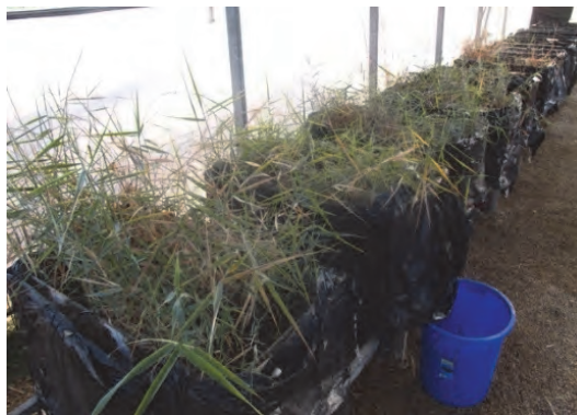
Figura 11.6. Mesocosmos experimentales (con y sin Phragmites australis ). Se aprecia uno de los bidones para la recogida del agua de drenaje al final de cada fase de inundación.
