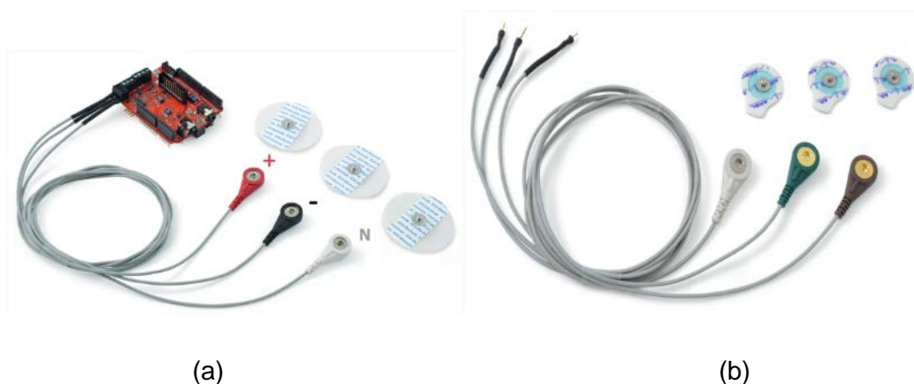
Fig.7. Cables y electrodos para ECG (a) y para EMG (b)
