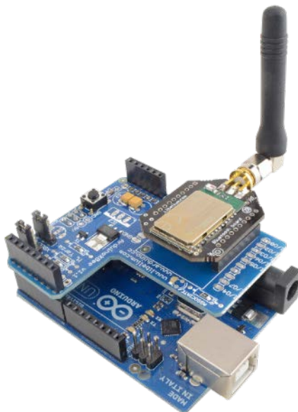
Fig.8. Módulo Bluetooth PRO montado sobre Shield de comunicaciones XBee a su vez montado sobre Arduino ONE.
