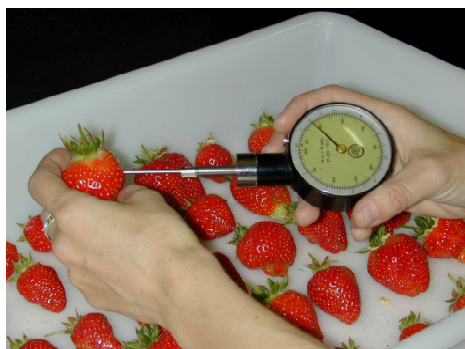
Figura 3.6: Medición de dureza en frutos de fresa con el penetrómetro (autor: Silvia Jiménez-Bermúdez. Fotografía usada con permiso del autor).
