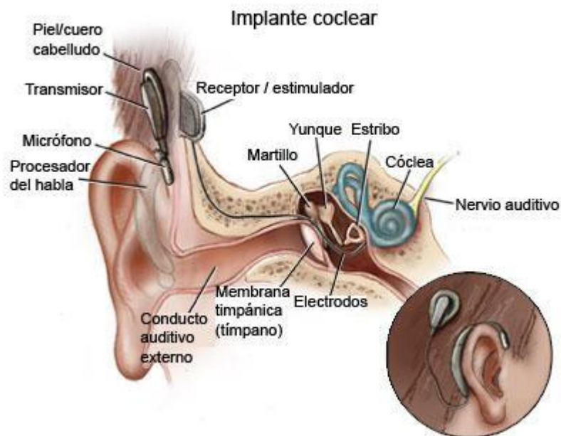
IMAGEN 5. Partes de un implante ( http://www.seattlechildrens.org/kids-health/parents/para-padres/la-salud-general/los-implantes-de-c_clea/ )
