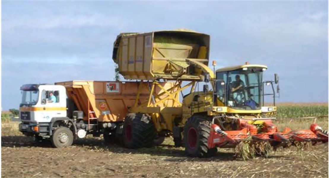
Figura 10. Traspase de forraje de la cosechadora con tolva.
