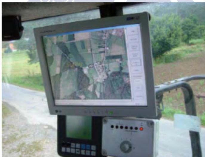
Figura 5. Monitor táctil instalado en una de las cosechadoras
