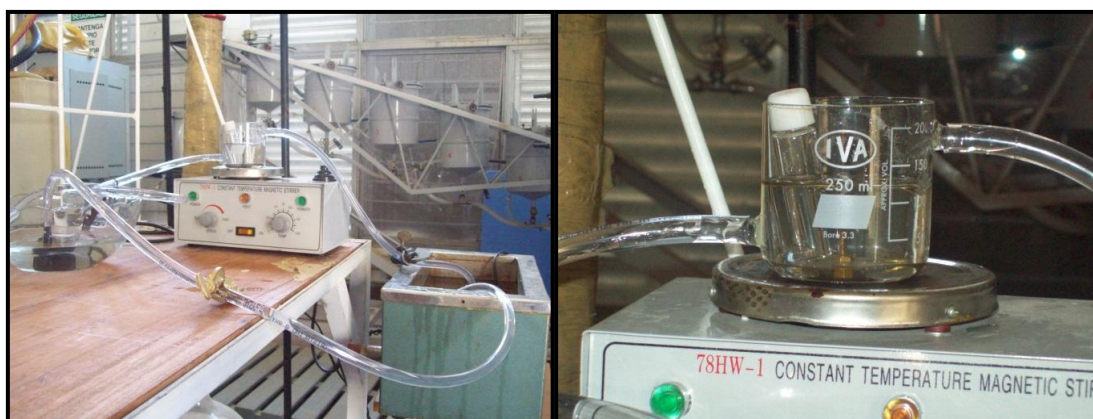
Figura 4.3. Baño termostatzado con agitación magnética empleado para las reacciones de decoloración de RAS
