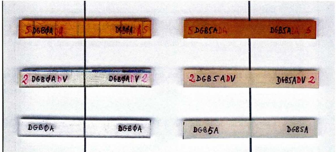
Figura 4.38. Degradación a 150° C en vacío y en aire del epoxy neto y modificado
