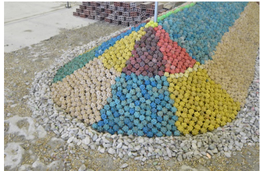
Figura 3- 10 Cubípodos colocados en el morro pequeño en los tres modelos
