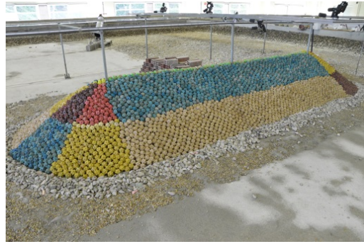
Figura 3- 12 Cubípodos colocados en el tronco en los tres modelos
