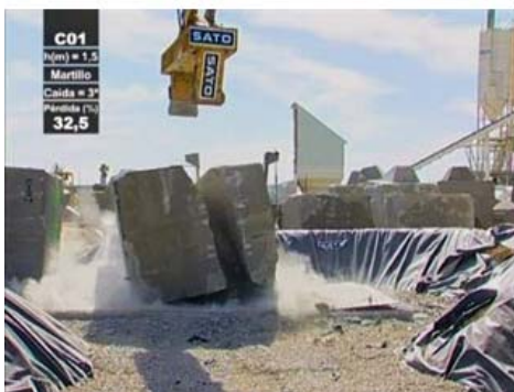
Figura 2- 20 Comparación de la resistencia estructural del cubo y cubípodo, Cubipod, (2016)
