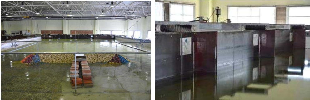
Figura 3- 2 Izquierda: Dársena de oleaje del CITEEC. Derecha: Palas generadoras de oleaje
