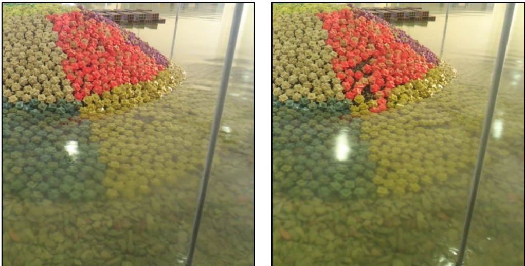
Figura 5- 5 Asentamientos producidos en el ensayo 3
