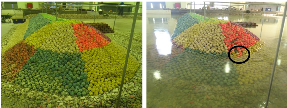
Figura 4- 2 Izquierda: Estado inicial. Derecha: H_s [cm]=13.8 en ensayo del ensayo 3
