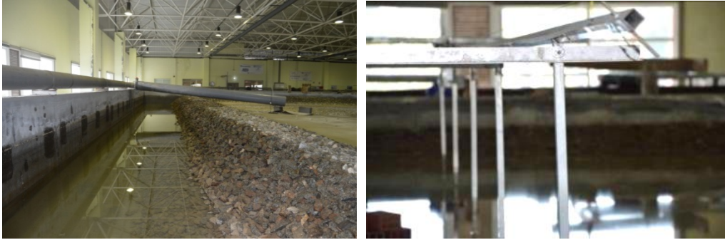
Figura 3- 4 Izquierda: Playa de disipación trasera. Derecha: Detalle de la estructura metálica
