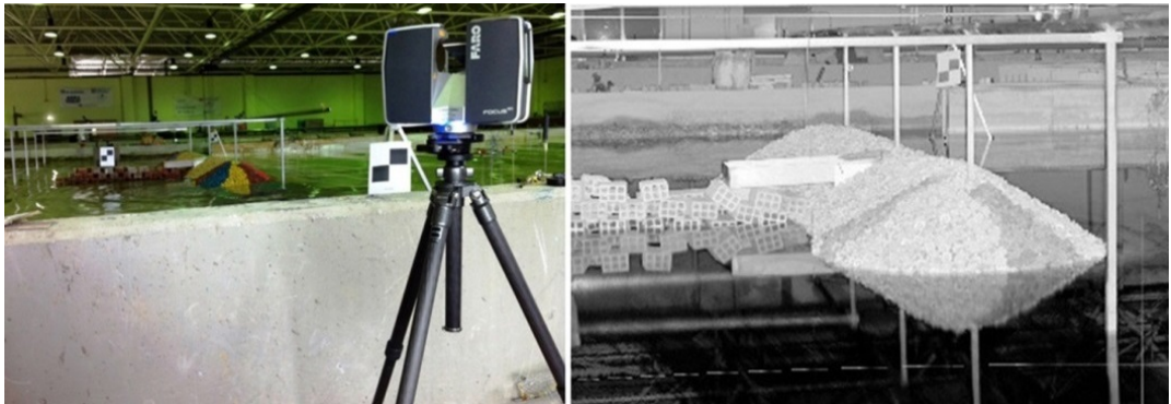
Figura 1- 9 Izquierda: Faro Focus 3D 120 durante la adquisición de datos. Derecha: Vista de una nube de puntos obtenida con Faro Focus 3D del morro.
