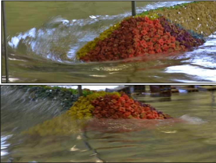
Figura 5- 21 Set Down y Set Up del flujo en los morros monocapa de cubípodos.
