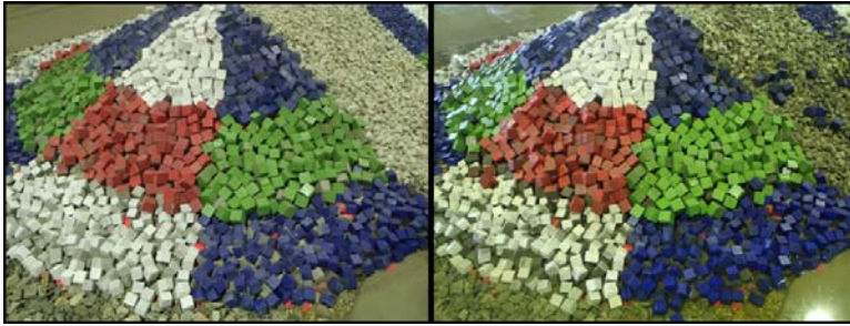
Figura 2- 40 Situación inicial y final del morro bajo incidencia paralela. (Peña et al., 2012)
