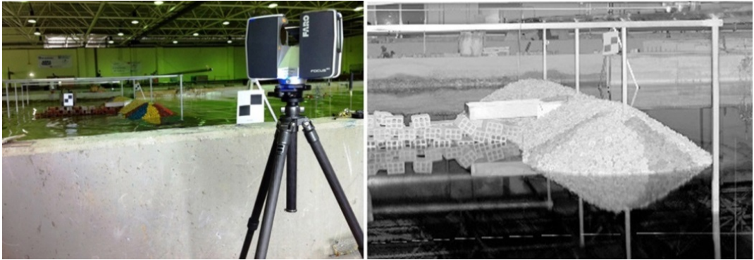
Figura 3- 33 Izquierda: Faro Focus 3D 120 durante la adquisición de datos. Derecha: Vista de una nube de puntos obtenida con Faro Focus 3D del morro
