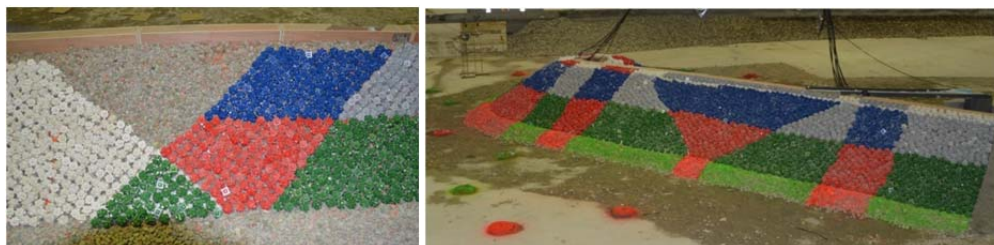
Figura 6. Transición monocapa-bicapa de Cubípodos de W[t]=24 y Modelo del Morro ensayado en el CITEEC.
