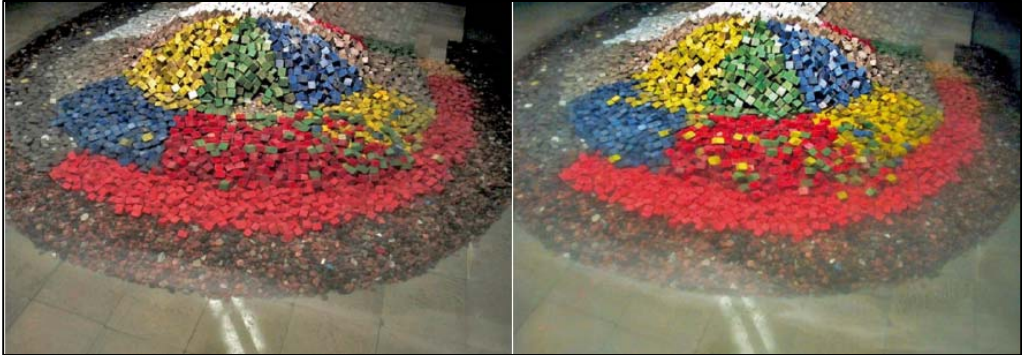
Figura 6- 23 Comparación de dos morros analizados por E. Maciñeira & Burcharth (2016). Izquierda: destrucción con D [%]=27. Derecha: D [%]=29 y sin destrucción.
