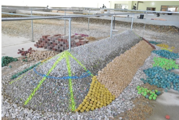
Figura 3- 15 Colocación de los cubípodos respetando los ángulos de construcción
