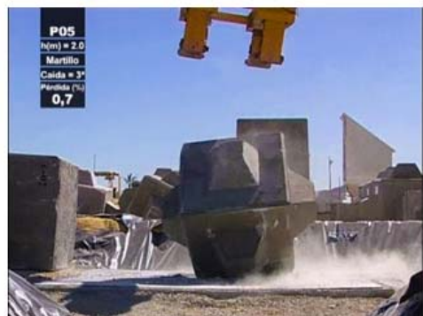
Figura 2- 20 Comparación de la resistencia estructural del cubo y cubípodo, Cubipod, (2016)
