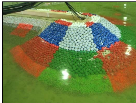
Figura 2- 25 Inicio de averías en un morro bicapa de cubípodos.
