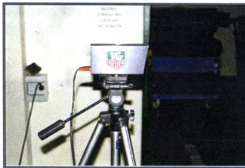
Fig. 16. Fotocélulas Heuer © incorporadas al sistema DAS-DAM.
