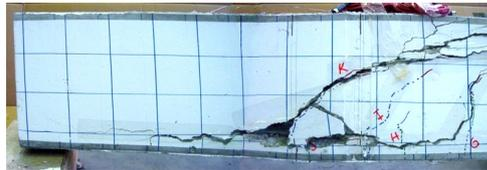
**Figura 57. Ejemplo de rotura por falta de armadura transversal.**
