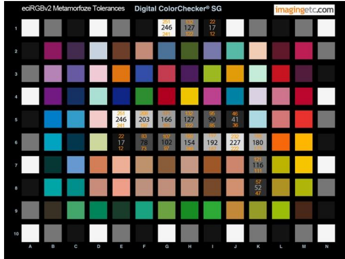
Fig. 7- Valores e tolerâncias dos neutros na Metamorfoze e no espaço de cor eciRGBv2 com a mira DCSG
