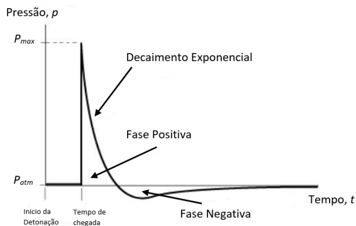
Figura 2.7: Variação de Pressão em função do tempo à passagem de uma onda de choque, adaptado de [24].
