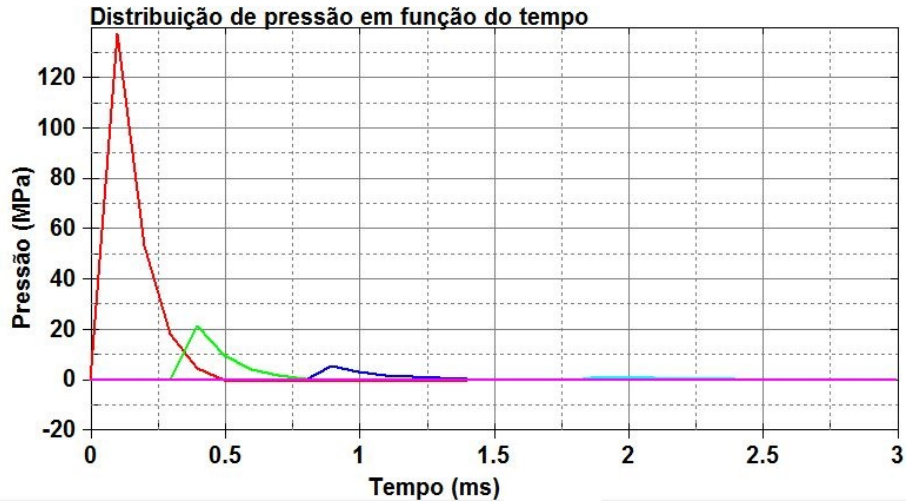
Figura 5.8: Curvas de pressão provocada pela onda de choque, detonação no instante inicial.
