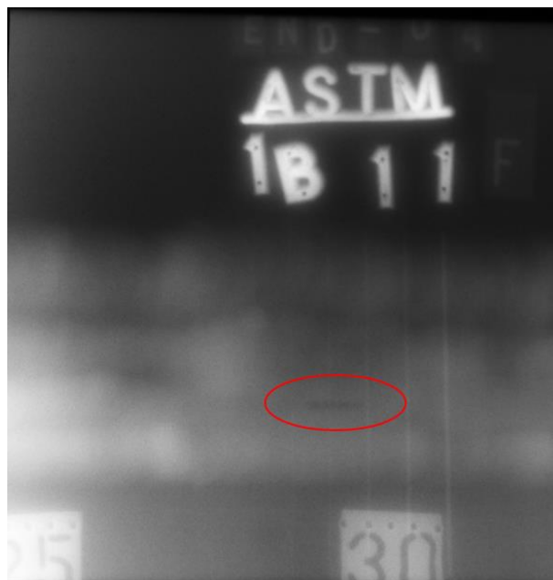
Figura 3.30 - Identificação da uma descontinuidade com radiografia convencional no mockup END-04.
