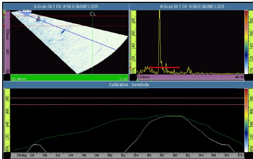
Figura 3.21 - Calibração da uma curva TCG com uma lei focal.
