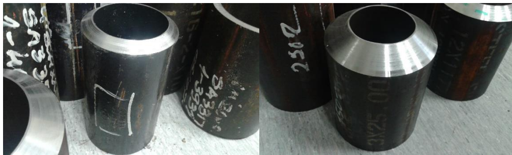
Figura A.19 - Preparação dos tubos e de chanfros.
