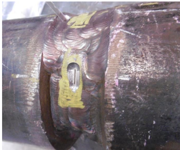
Figura 3.10 - Processo de fabrico de entalhes no mockup OD4 com 22,5 [mm] de espessura.
