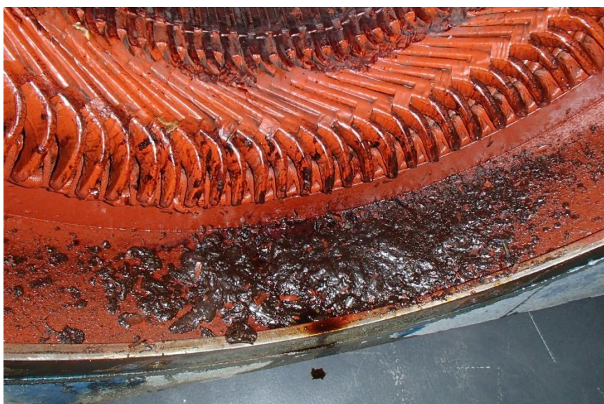
Figura A.9. Excesso de massa lubrificante no interior
