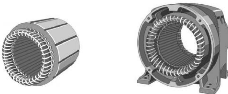
Figura 4.3. Estator (esquerda) e estator inserido na carcaça (direita) (Francisco, 2006)
