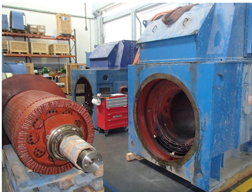
Figura A.1. Motores desmontados
