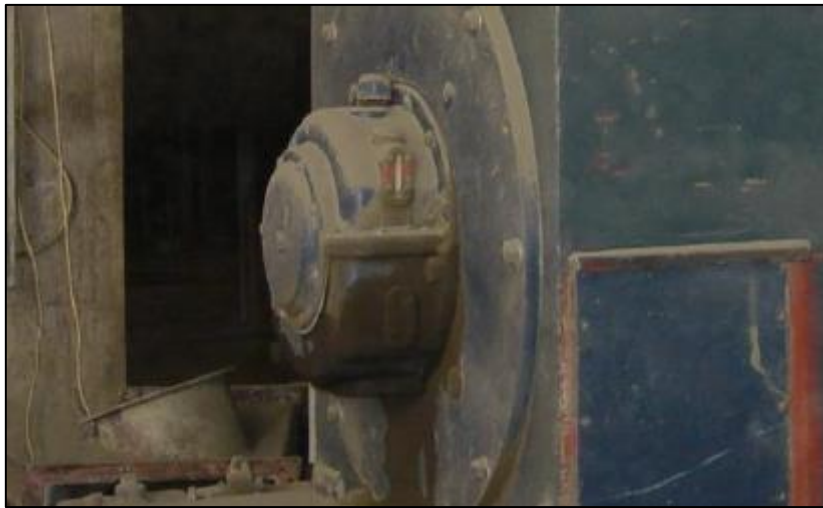
Figura 4.9. Exemplo de um motor mal lubrificado
