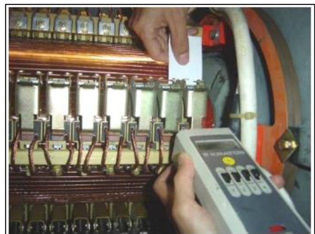
Figura 4.16. Medição da pressão exercida pelas escovas
