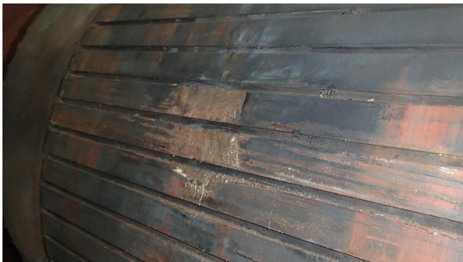
Figura A.5. Cobre do estator fundido com a chaparia do rotor
