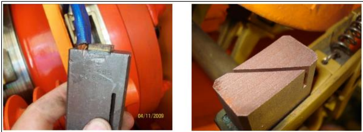
Figura 4.15. Verificação das escovas de um motor
