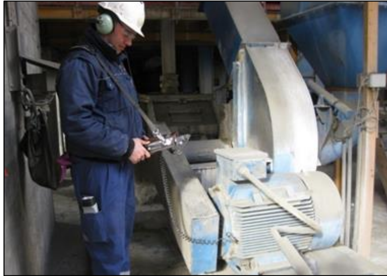
Figura 4.10. Recolha de dados de uma análise de vibrações
