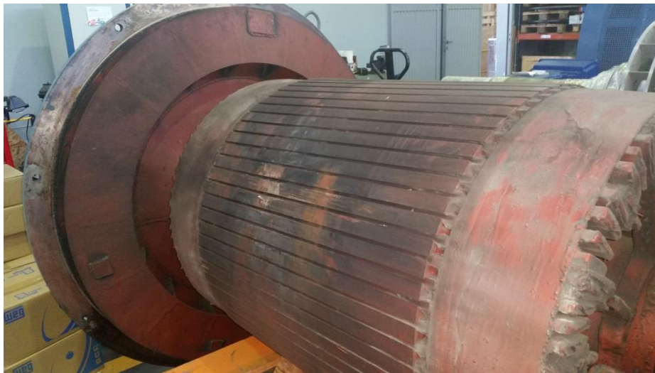
Figura A.4. Presença de sujidade no rotor do motor nº 1
