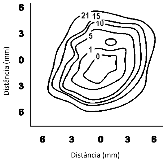
Fig. 1 - Mapa de contornos de concentrações de oxigénio em redor de uma partícula de solo obtido com recurso a um microelétrodo. Os eixos indicam as dimensões da partícula; os números nos contornos indicam a concentração de oxigénio (em percentagem; o ar contém 21 % O 2 ). Cada zona pode ser considerada um microambiente distinto.
