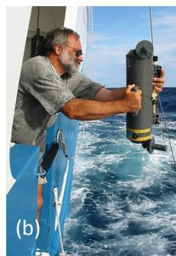
**Fig. 4** - Equipamentos de recolha remota de amostras de água: (a) garrafa de Van Dorn, (b) garrafa de Niskin. As tampas na extremidade dos dois tipos de garrafas mantêm-se abertas até ser largado um “mensageiro”, pelo cabo que as segura (quando é atingida a profundidade requerida), e cujo embate as liberta, fechando rapidamente as garrafas e aprisionando a amostra de água.
