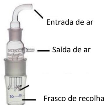
**Fig. 8** - Amostrador de vidro SKC, semelhante ao AGI-30 (retirado de <http://www.airmet.com.au>).
