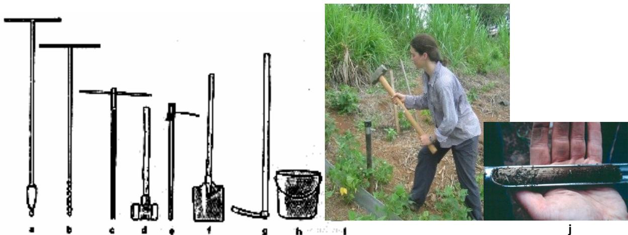
**Fig. 1** - Exemplo do equipamento utilizado na amostragem de solo e sedimentos: diversos tipos de sondas (a) a (c), martelo (d), pá, enxada (f, g), balde (h); entrada de sonda de 60 cm de comprimento no solo (i); sonda de aço, aberta, com solo no seu interior (j).
