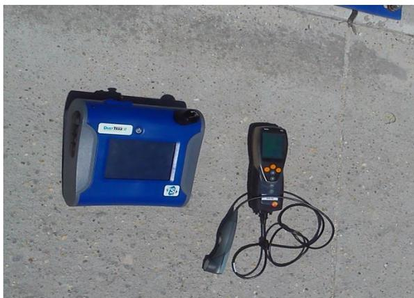
**Figura 17 - Equipamentos de registo de PM<sub>10</sub> e de CO**
