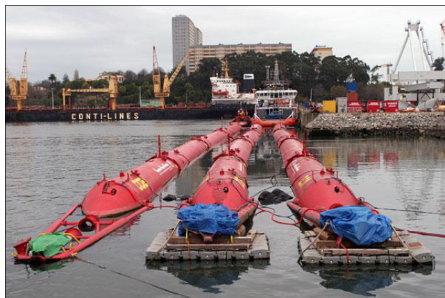
Figura 5.31 - Parque de energia das ondas Pelamis em Aguçadoura, Póvoa de Varzim [PER, 2014c].
