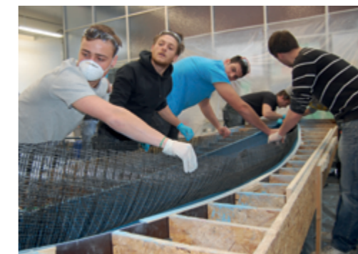
Vorsichtig passen die Studierenden die innovative Carbonbewehrung in das Kanu ein.
