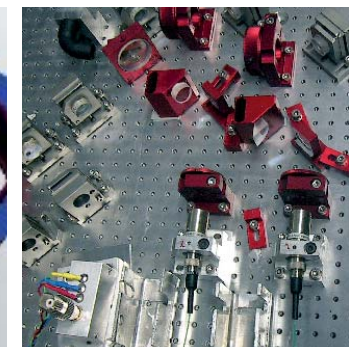
Detailansicht des neuen Interferometer-Aufbaus. Unten rechts erkennt man die Faserauskopplungen der beiden Laserstrahlen
