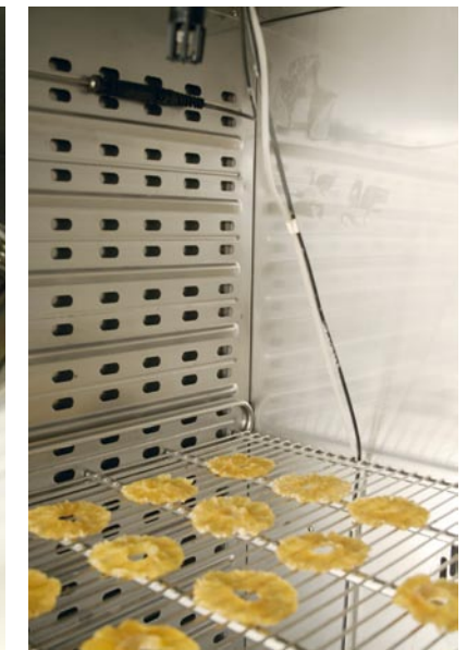
Links: Ein umgebauter Wäschetrockner sorgt für eine ständige Bewegung der Lebensmittel beim Trockenvorgang. Rechts: Im Klimaschrank lassen sich Temperatur und Luftfeuchtigkeit individuell einstellen. Gut geeignet für Ananas, da sie nicht vollständig austrocknen dürfen.
