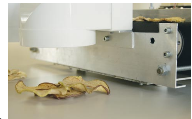
Mit der »Apfelring-Sortiermaschine« können zu kleineren oder verformte Ringe ausgesondert werden.
