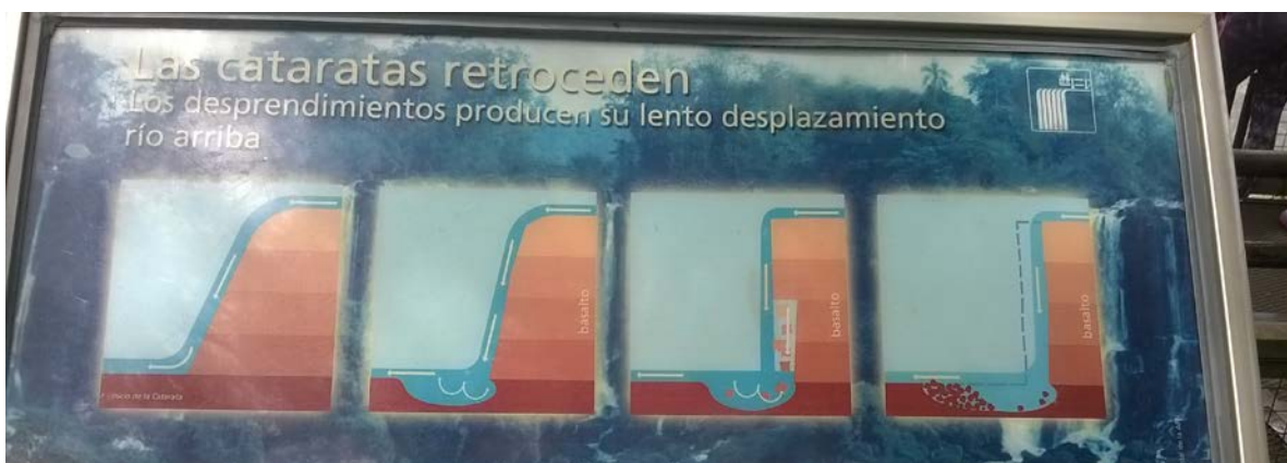
Bild 4: Erosion der Felskante durch Kolkbildung (Foto: Kristina Ihlow)
