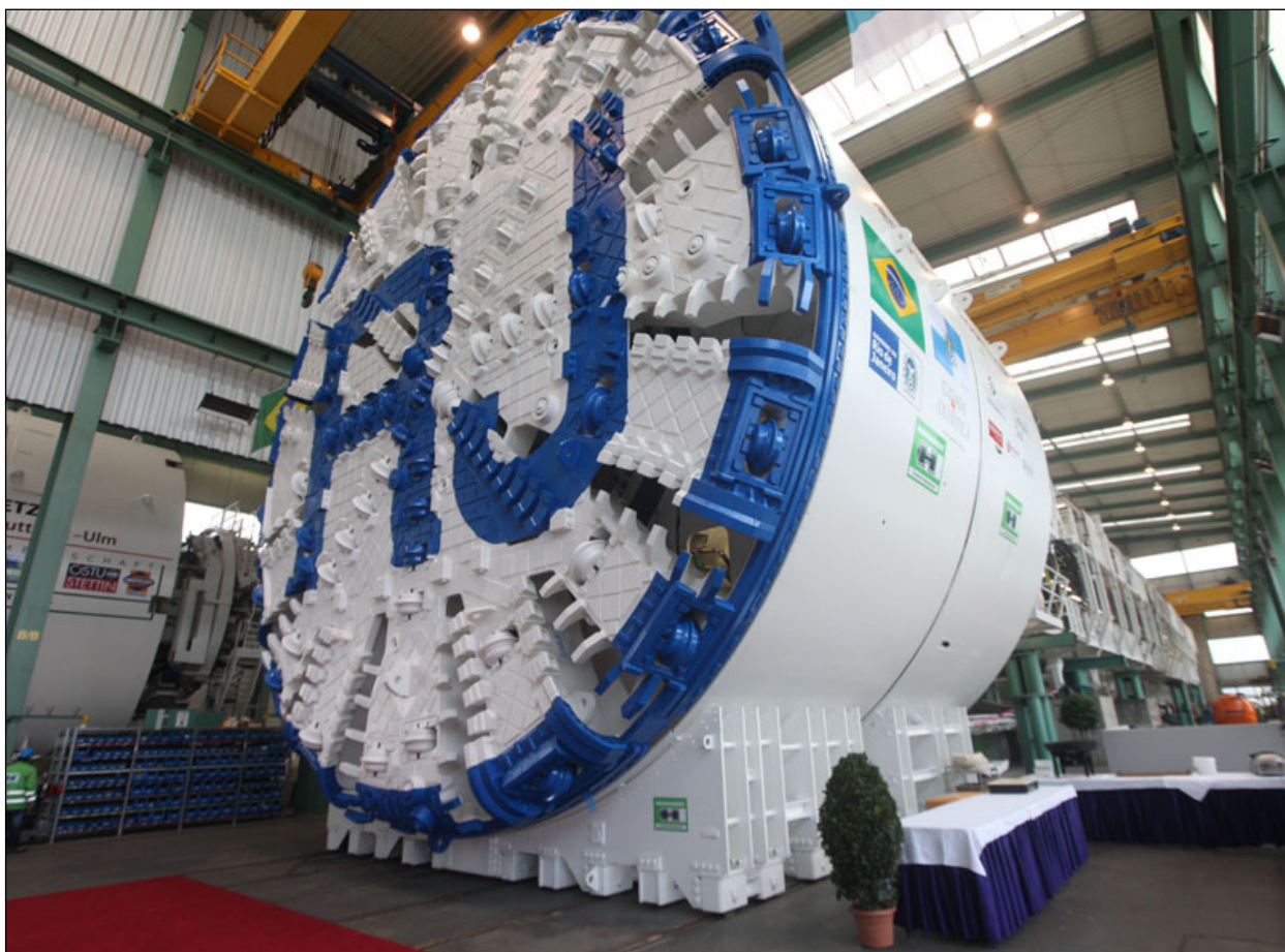
Bild 3: TBM Typ Multi-Mode-TBM der Fa. Herrenknecht [4]
