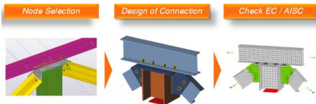
Slika 3.3: Izbira vozlišča v TS, API-vmesnik z IDEA Statica, preveritev po EC/AISC
