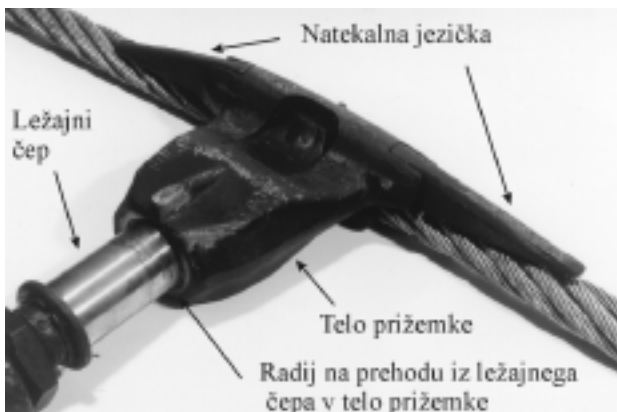
Slika 1: Karakteristični deli prižemke, njena lega na vrvi in statične obremenitve
