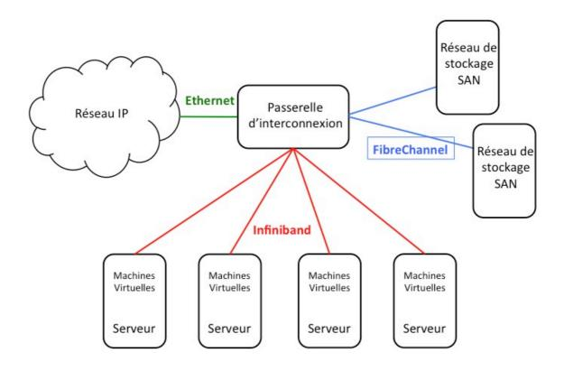
Figure 1 : Architecture d'un réseau de centre de données.
