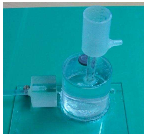
Figura 6: Setup para la medición de la variación de la presión en tiempo.
