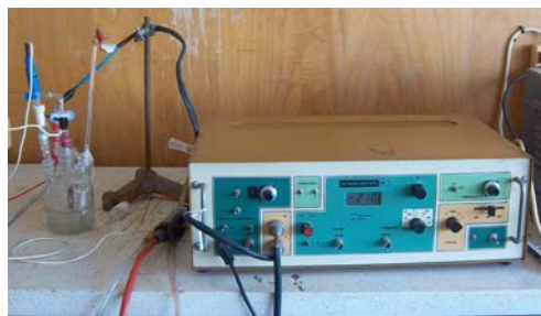
Figura 2. Celda electroquímica (izq.) conectada al potenciostato (der.)
