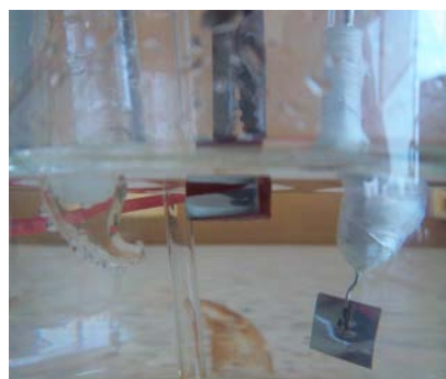
Figura 3. Electrodo de referencia con el capilar de Luggin, electrodo de trabajo con la probeta en estudio, y contraelectrodo de platino.
