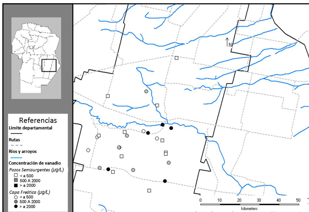
**Figura 1.** Sitios de procedencia de las muestras de agua analizadas, tipos de fuente de agua y rango de concentraciones de V presente en las mismas.
