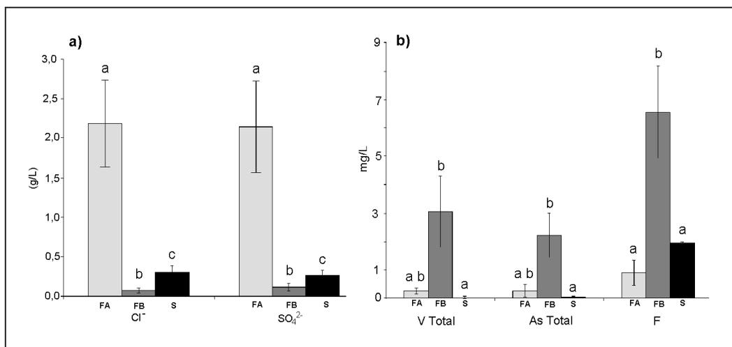
**Figura 4.** Concentración de (a) *elementos mayoritarios*: cloruros (Cl<sup>-</sup>), sulfatos (SO<sub>4</sub><sup>2-</sup>) y (b) *elementos traza*: V, As y F en los distintos grupos de muestras: FA, FB y S. Medias con una letra común no son significativamente diferentes ( $p > 0,05$ ).
