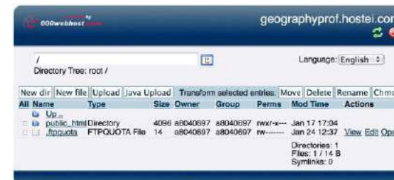
Figura 14.3 - La finestra di un File Manager da un servizio di hosting online . Tale servizio permette di creare ed editare i file . Tutti i file a disposizione sul web devono trovarsi nella directory/cartella public_html . (© 2014 First Class Web Hosting)
