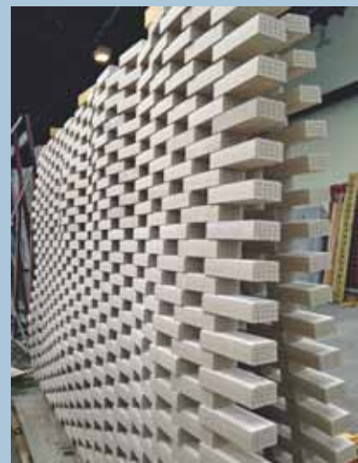
Moduli preassemblati in stabilimento.
